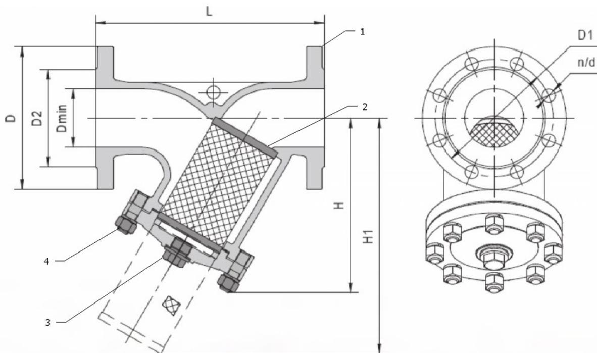
Рис. 1. Фильтр сетчатый Y-образный (литой корпус).
