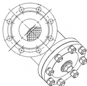
Габаритные и присоединительные размеры фильтров сетчатых тип Y с литым корпусом из стали 20Л. Размеры в мм.
