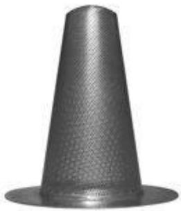
Фильтрующий элемент конусных фильтров имеет каркас, выполненный в форме конуса, который имеет два слоя: защитный для жесткости в виде перфорированной обечайки и фильтрующий слой, мелкоячеистая сетка из нержавеющей проволоки, непосредственно предназначенная для очистки проходящей среды. При необходимости, фильтрующая сетка заключается между слоями армирующих сеток.
